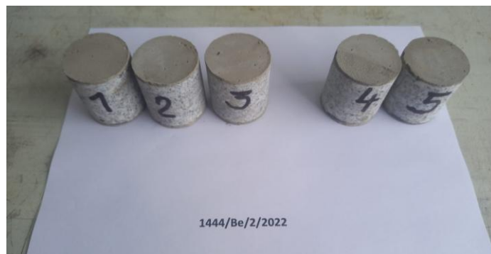
FOTO č.3.4: Dokumentace vzorků pro destruktivní zkoušky kamene opěr
