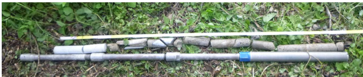
Foto 3.2: Dokumentace vývrtu ke zjištění tloušťky opěry - sonda SK3
