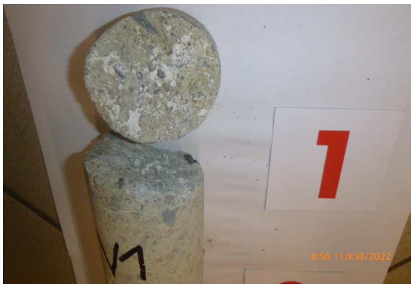
Foto 3.5: Dokumentace plochy trhliny ve vrtu V1+V2 s inkrustacemi
